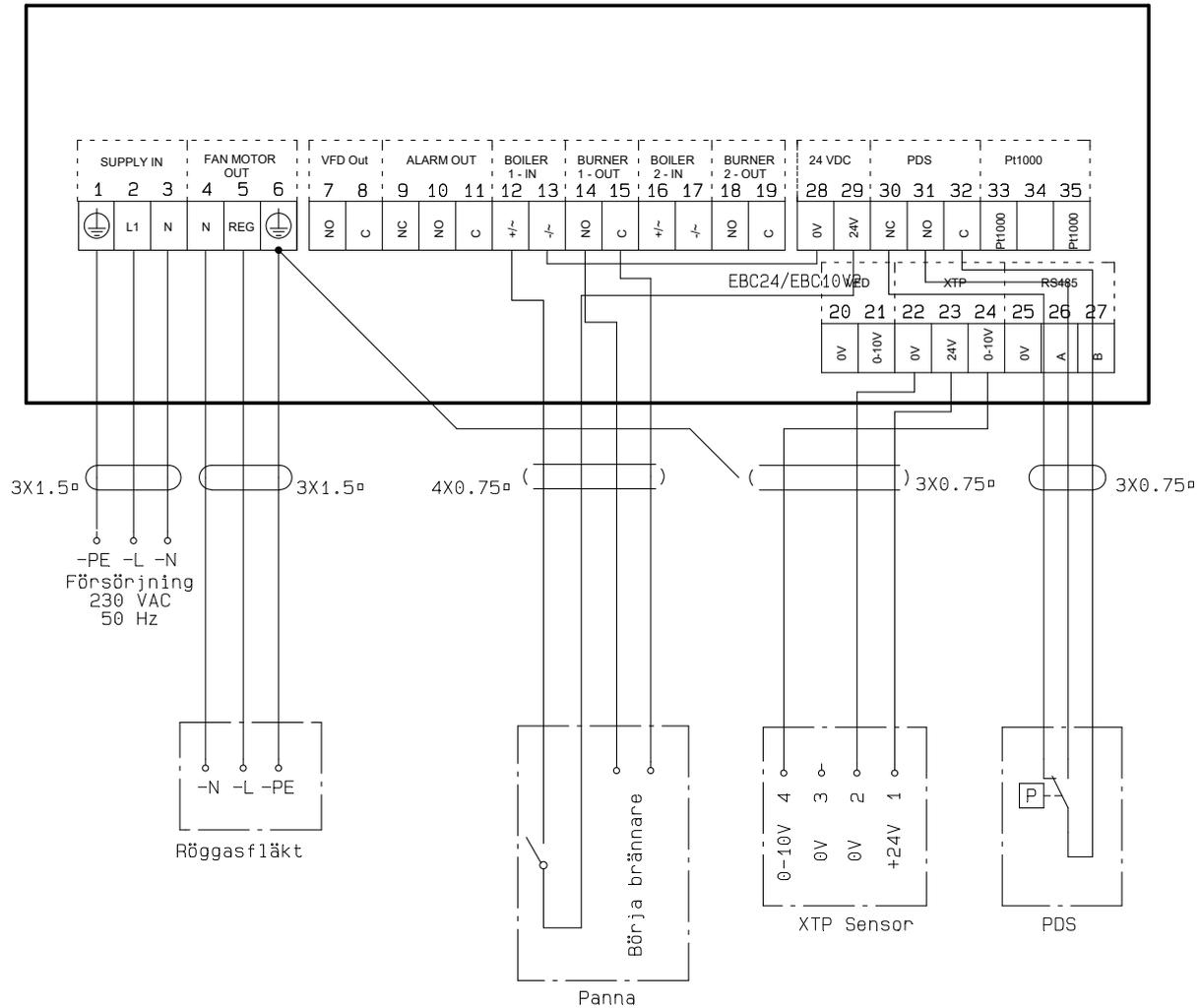
Detta exempel visar hur du ansluter en PDS till EBC24. PDS är en extra övervakning.
