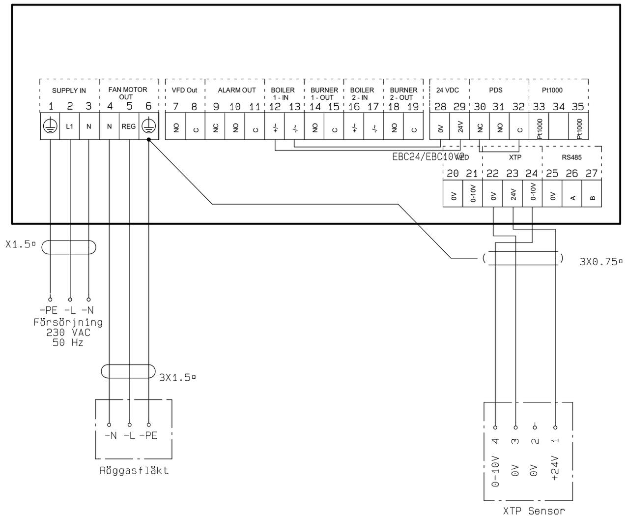
Detta exempel visar hur du ansluter en spänningssignal (24 V DC) för EBC10v2 för att starta röggasfläkten.
