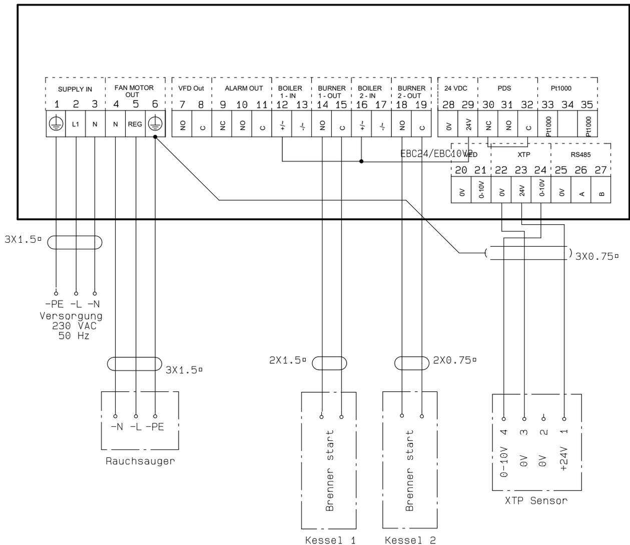
Dieses Beispiel zeigt, wie Sie den Regler EBC24 anschließen, wenn Sie den Dauerbetrieb des Schornsteininventators benötigen:
