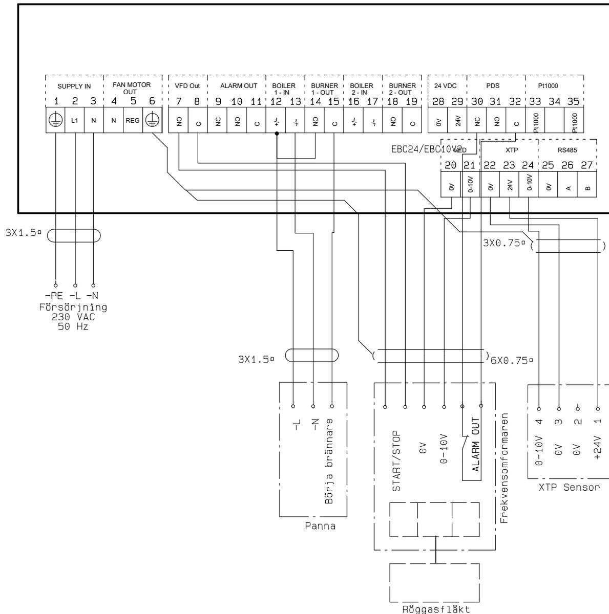
Detta exempel visar vilka ingångar/utgångar på EBC24 som ska anslutas till frekvensomformaren när röggasfläkten ska regleras via en frekvensomformare:
