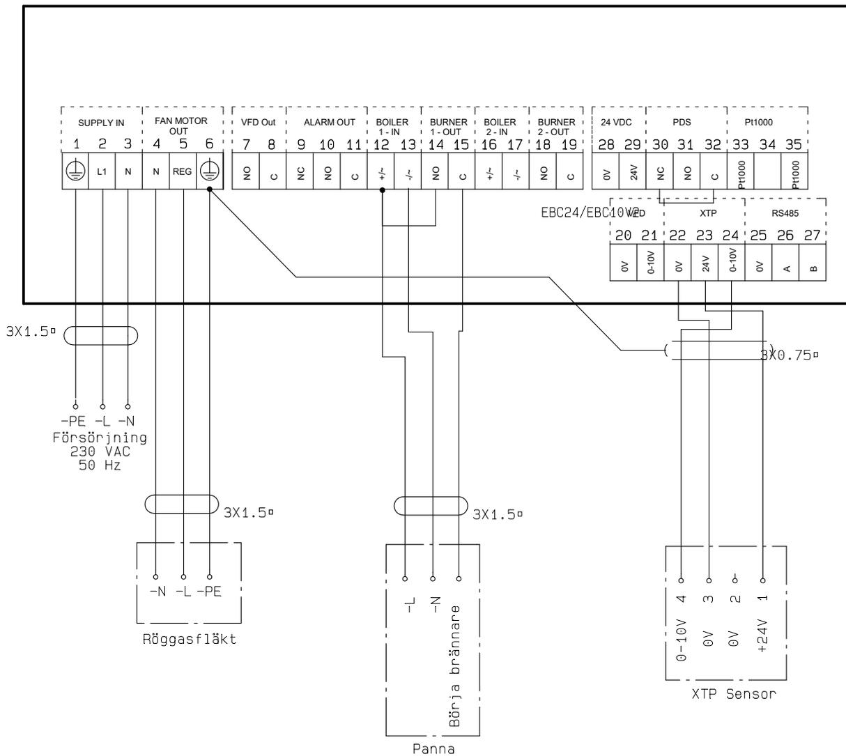
Detta exempel visar hur du ansluter en spänningssignal (10–230 V AC/DC) för EBC24 för att starta/stoppa rökgasfläkten.
