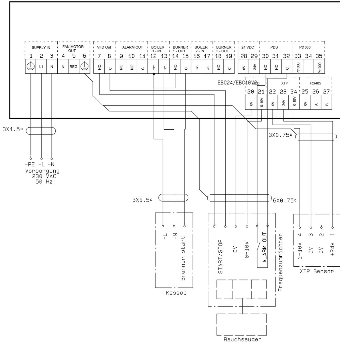
Dieses Beispiel zeigt, welche Eingänge / Ausgänge am EBC24 an den Frequenzumrichter angeschlossen werden müssen, wenn man zur Steuerung des Schornsteingeblasses verwendet wird:
