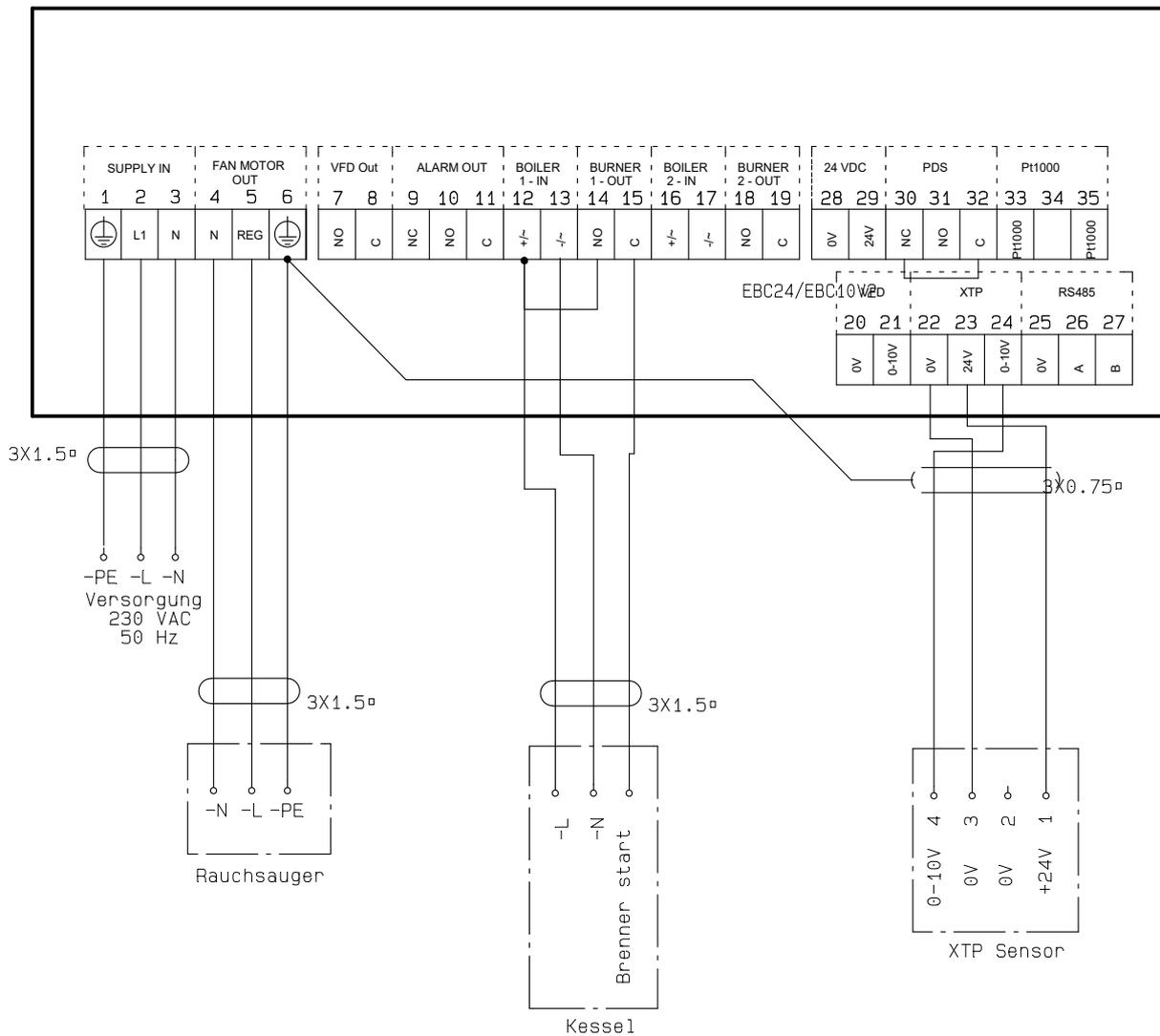
Dieses Beispiel zeigt, wie ein Spannungssignal (18-230 V AC / DC) an EBC24 angeschlossen wird, um den Rauchsauger zu starten/zu stoppen:
