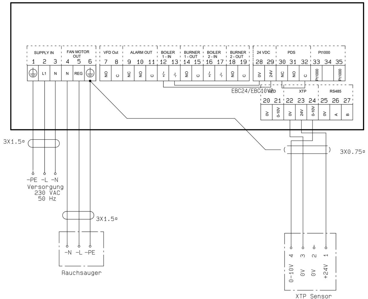
Dieses Beispiel zeigt, wie ein Spannungssignal (24 V DC) an EBC10v2 angeschlossen wird, um den Rauchsauger zu starten / zu stoppen.
